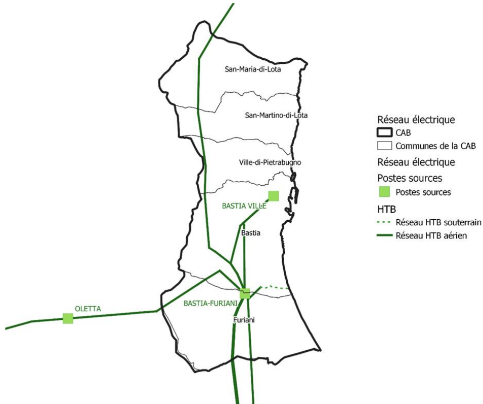
Figure 65 : Réseau électrique Haute Tension (HTB) de la communauté d'Agglomération de Bastia – Source : ARTELIA, EDF SEI, 2024
